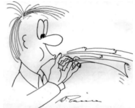
Das gleiche Prinzip findet sich an der Tragfläche von Flugzeugen. Durch die stärkere Wölbung der Flügeloberseite ergibt sich ebenfalls eine Art Engstelle. Nach unten begrenzt durch den Flügel, nach oben durch die laminar (quasi gerade) vorbei strömende Luft, fließen die Luftanteile, für die der Flügel ein Hindernis darstellt schneller über den Flügel, als darunter her.
