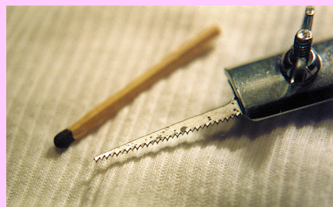
Bild 8.19: Eine Schlüssellochsäge ist nichts anderes als der allgemein bekannte „Fuchsschwanz“, allerdings in Miniausführung.
