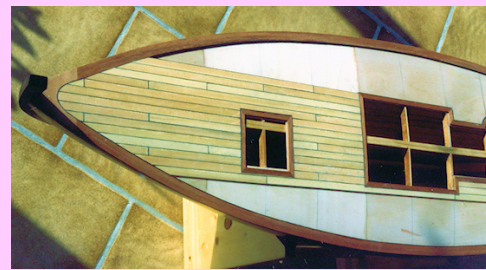
Bild 8.3: Aufgrund seiner dreidimensionalen Wölbung muss das Sperrholzdeck aus mehreren Segmenten zusammengesetzt werden. Bei der Wahl der Segmentgröße sollte darauf geachtet werden, dass keines der Segmente längsschiffs kürzer ist als zwei bis drei Decksbalkenabstände.
