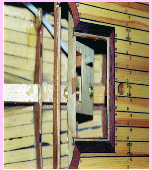
Bild 8.6: Bei vielen Vorbildern sind die Leibhölzer aus durchgehenden Brettern oder Balken gefertigt worden. Auch die Verbindung der Hölzer an den Ecken auf Gehrung wurde in der Bootsbaupraxis oft angewendet. Im Inneren des abgebildeten Modells ist das in Kapitel 6.7 beschriebene Servobrett erkennbar. Das dreidimensional gebogene Kunststoffrohr dient der Führung der Großschot.
