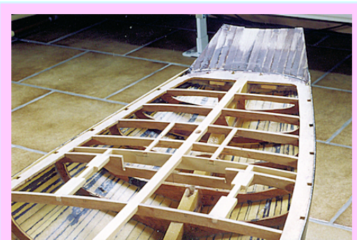
Bild 8.4: Die entlang der Öffnungen für die Aufbauten eingezogenen Gurte bieten den Sperrholzsegmenten des Unterdecks auch in diesen Bereichen eine sichere Auflage.
