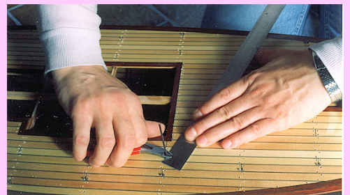
Bild 8.7A: Die Holznägel am Modell eines beinahe 100 Jahre alten Lotsenkutters sind aus dunkel gebeizten Zahnstochern hergestellt worden. Die Zahnstocher habe ich trocken in passgenau vorgebohrte Löcher gesteckt bis sie klemmten und so wie auf dem Foto dargestellt mit Überstand (ein Stahllineal diente als Abstandhalter) gekürzt. Anschließend habe ich an das Hirnholz jeden Holznaegels einen Tropfen dünnflüssigen Sekundenkleber gegeben. Das trockene Holz des Zahnstochers leitete den Kleber wie ein Docht zur Klebestelle in der Bohrung und sorgte für eine zuverlässige Verklebung. Das Ergebnis der Bemühungen können Sie in Bild 8.23 begutachten.
