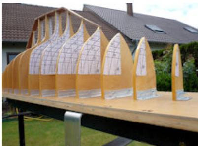
Mit Metallwinkel werden die Mallen auf der Helling aufgestellt. Hier noch mit Doppelklebeband
