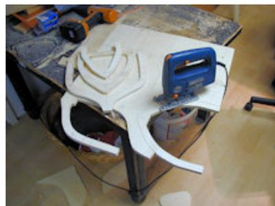
Mit der Sticksäge wird ausgesägt
