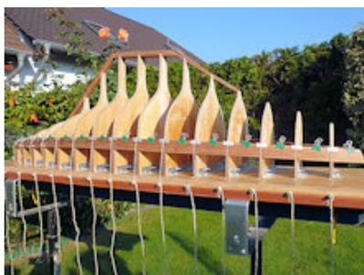
Sinnvoll fängt man dem Deckssprung angepaßt zu Beplanken an.
