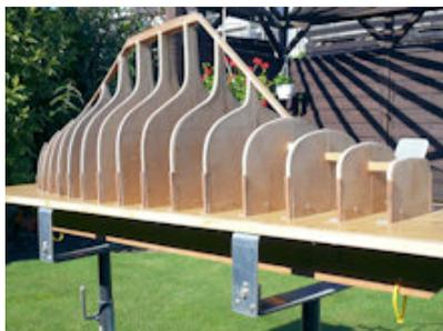
Kiel-, Bug- und Heckleisten werden hier eingepaßt, auch Wasserlinie- und "Scheuerleisten"
