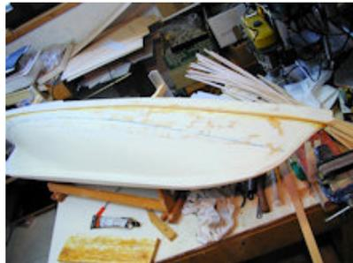
Die überstehende Scheuerleiste wird als erste angebracht
