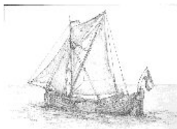
Hecktjalk mit Hochnock-Sprietsegel, Toppsegel, Fock und Klüver, aber ohne Druilmast, (Menzel, 31993, S. 29)
