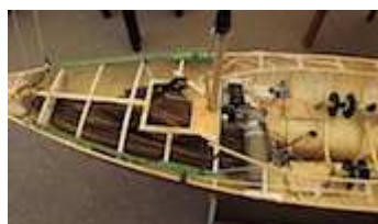
Bild 05: Hier die "Ruhestellung": Der Spi ist durch die "Trompete" auf dem Vorschiff (Holz-Ring; ganz links im Bild) von einer Walze (grau) unter das (noch nicht vorhandene) Deck hereingezogen, z.T. aufgewickelt worden. Die Spi-Bäume (grüne Flach-Metall-Stangen), an denen die unteren Schothörner des Spi's befestigt sind, liegen auf dem (imaginären) Vorderdeck
