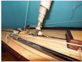
Bild 20: Abrollen: Zahnräder entkoppelt; die Fock kann durch Zug an den Schoten entrollt werden
