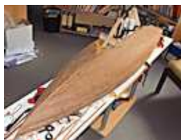
Bild 02: Dank der exakt konzipierten und gelaserten Spanten ging der Rumpfbau schnell vonstatten
