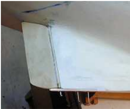
19. das Ruder wird eingepaßt
