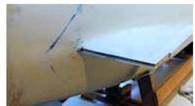
18. das Ruder wird in diese Nut eingelassen
