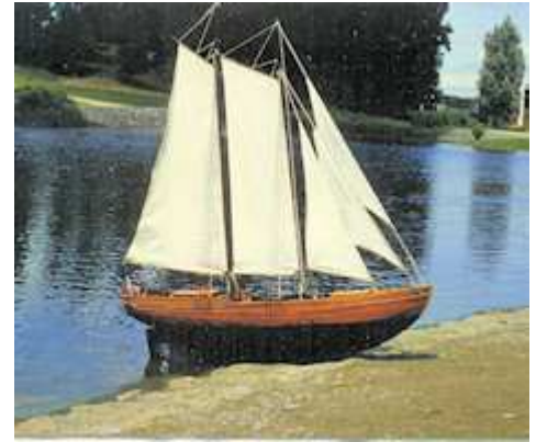
3. ohne "Geschwür" drunter dafür aber mit einem 2 mm dicken Messingblechstreifen unten konnte das Modell mit zwei Fingern bequem an Land gezogen werden
