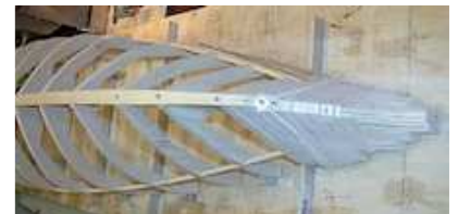
12. mit Abfallstückchen wird der Bugbereich aufgefüllt
