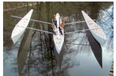
BILD 02: erste Trimmversuche Test der möglichen Zuladung in Form von mehrerer Hämmer ....
