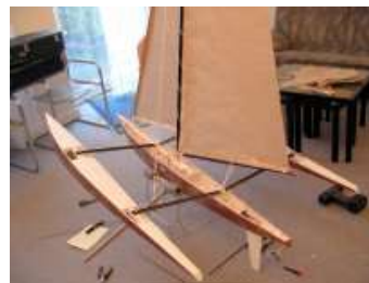
BILDER 03 und 04: provisorisches Test-Rigg im Wohnzimmer ... gut zu erkennen das ziemlich weit vorne positionierte Schwert
