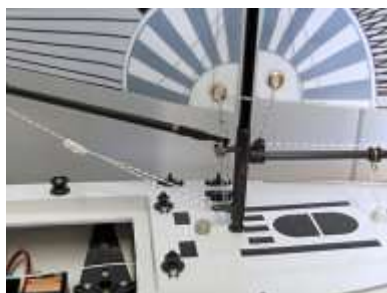
Bild 6 - neuer Mast mit Großbaumbeschlag
