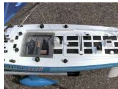
Bild 8 - der neue Lukendeckel
