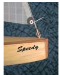
Bild 7 - Sicherungdraht im Wantenspanner
