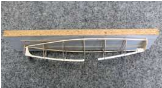
Spanntgerippe mit Ausschnitt Kieltasche, gut zu sehen sind die Hilfsbrettchen, mit dem Hellingbrett verklebt
