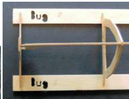
Bild 2b - Die Spanten stecken in den Hilfsbrettchen
