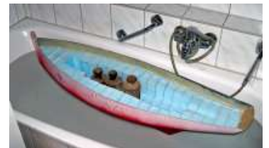
Ermittlung von Ballast und Gewichtsschwerpunkt
