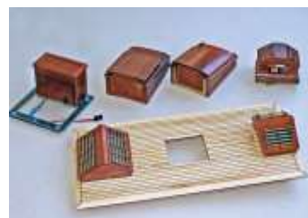
Lampen und Lampenborde vorbereitet für Befestigung an den Wanten
