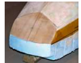
Heckspiegel angeharzt, Teppichklebeband angebracht
