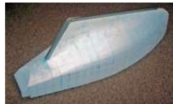
Rumpf bearbeitet, Aluschiene an Kiel und Achtersteven
