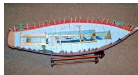
Rumpfeinbauten eingearzt, Schanzkleid innen verstärkt
