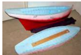
"Hilfs"-Rumpf in Höhe Schanzkleidoberkante abgesägt
