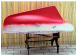
Unterwasserbereich mit roter Grundfarbe gespritzt
