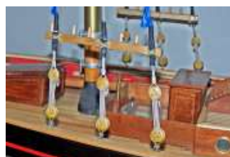
Handlaufteile mit Juffern an Wanten befestigt
