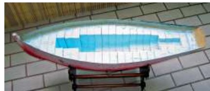
restliches Styrodur bis auf Deckshöhe entfernt
