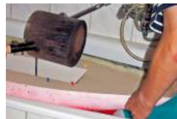
ein dünner Strahl flüssiges Blei fließt in den Rumpf
