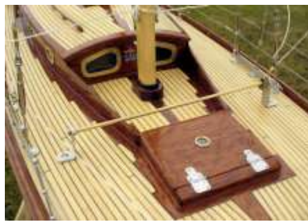
Der Mastsschuh mit Moosgummiabdichtung
