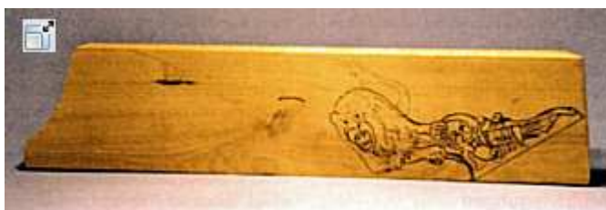
Die Löwenfigur ist auf das Stück Buchsbaum übertragen; jetzt werden die Umriss ziemlich genau mit der Bandsäge ausgeschnitten
