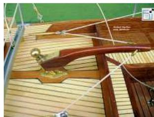
Dieses Bild zeigt die Anlenkung der Pinne (Pflaumenholz), alle Beschläge selbst gefertigt.
