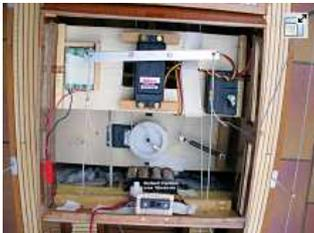
Ein Blick ins Innere, Ruderservo, Segelwinde; das ganze wird gespeist von einem 6V-Bleiakku / 3 Ah im Vorschiff
