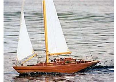
Mein erstes Segelschiff, die "Diva" gefällt mir so gut, daß ich beschloß sie ein zweites mal zu bauen. Des Segelverhalten der Diva besticht besonders bei Starkwind. Ich beschloß "sie" in ca. 1,5 m Länge zu bauen, hieraus kam fast über 20 kg Verdrängung. Das hohe Gewicht (Ballast über 12 kg) war ein gutes Pfand bei Starkwind, Windstärke 5 bis 6 Beaufort war überhaupt kein Problem, "sie" hüpfert auch nicht über die Wellen, sondern durchschneidet diese einfach.
