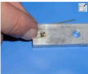
Biegen des ersten Auges in der oben beschriebenen Vorrichtung
