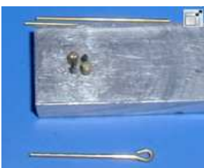
Das erste Auge ist fertig gebogen.
