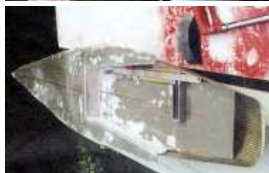
Rumpf und Deck warten auf Spachtel- und Schleifarbeiten.
