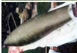
fertig laminiertes Rumpf
