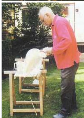
Über die Positivform wird dann der eigentliche Rumpf laminiert.
