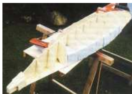
Die Spanten werden mit Styropor ausgefüllt, gestrakt, verschliffen und verspachtelt
