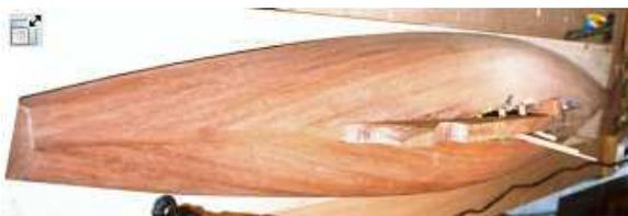
Die Leimung der Planken erfolgte mit "UHU hart", das garantiert absolute Wasserfestigkeit! Weißleime sind aus eigener Erfahrung nicht zu empfehlen.
