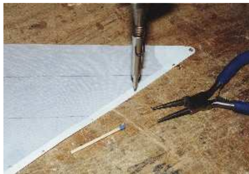
"Einschmelzen" der Kauschen mittel einem kleinen LötKolben
