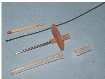
Werkzeug zum Einziehen der Enterlatten Einnähen der Enterlatten in die Wanten
