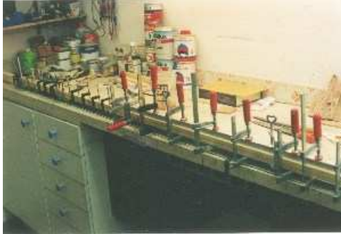
14. und 15. Der Mast mit dem Kohlefaserrohr beim Zusammenkleben
