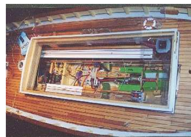
7. Das Rumpffinnere. Im Bug (links) die Hauptsegelwinde, das Grundbrett mit dem Ruderservo und dem Fahrmotor
