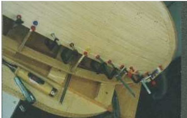
2. Beim Beplanken des Rumpfes, hier der Bugbereich.
