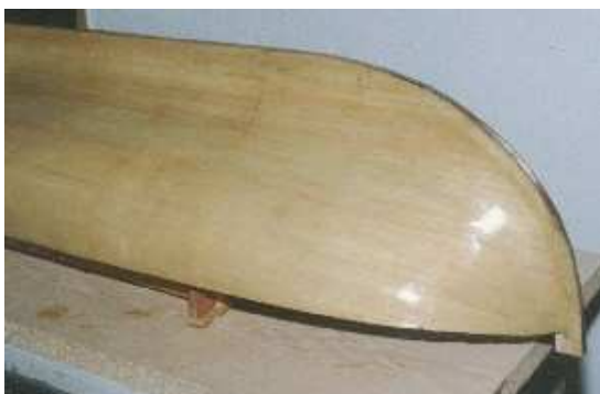
4. Der Rumpf fertig laminiert.
