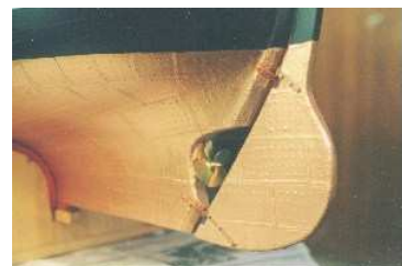
08. Die fertige Bekupferung am Heck
