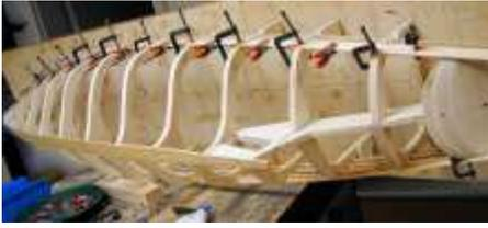
← Die erste ca. 2 cm breite erste Leiste wird aufgebracht (die Decksleiste überlappend)
