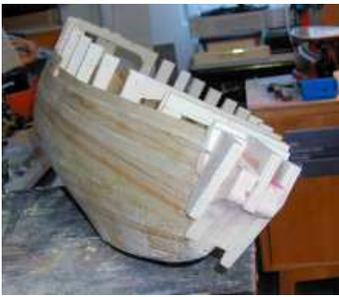
←← Bugbereich mit Abfallstücken, grob zugeschnitten, aufgefüllt, da ist die Bearbeitung mit der Flex angebracht
