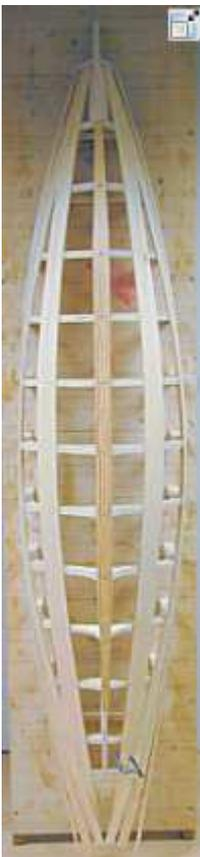
Die erste Leiste habe ich über die Deckslinie behelfsmäßig mit Klammern aufgelegt, mit Bleistift links und rechts auf den Spanten markiert und danach mit Weißleim Ponal (wasserfest!) geklebt und genagelt. Danach hab ich die anderen Leisten aufgebracht und schon mußte ich sie abhobeln, damit sie ohne seitliche Verspannung aufgebracht werden konnten. Wichtig dabei ist, daß man immer back- und steuerbord abwechselnd die Leisten aufbringt, damit sich der Rumpf nicht verzieht.
