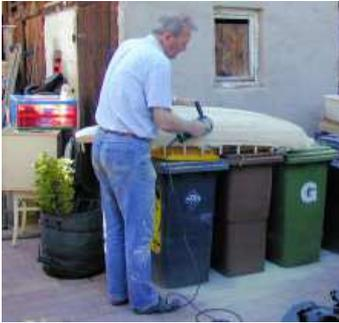
←← Schleifen des Rumpfes, hier zuerst mal ganz grob, danach wird überprüft ob aufgespachtelt werden muß.
