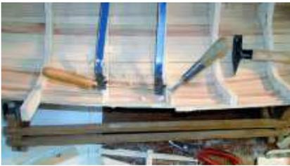
← Die überstehenden Spanten werden gekürzt und die aufgefüllten Teile freigelegt.
