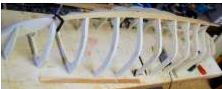
← Die "Kiel"-leiste sollte sorgfältig ausgemessen montiert werden. Die Spanten bekommen so genügend Halt für die nachfolgende Strakung und Einlassen der Decks- und Relingleiste. (Nur) hier ist gut zu sehen, daß der Kiel verbreitert wurde um den Zusatzkiel besser befestigen zu können. Der eigentliche Kiel wird nach dem Laminieren aufgebracht. Auf dem Brett sind auf der Vergrößerung die Markierungen früherer Schiffe zu erkennen.
