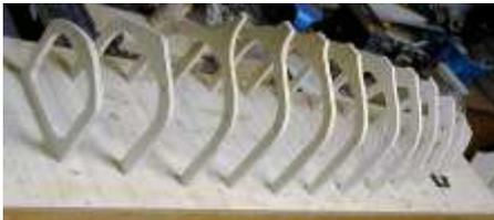
← Die Spanten werden aufgestellt (hier von unter her angeschraubt), die Spantabstände vorher genau aufgetragen. Mittlerweile schraube ich die Spanten an eine Reihe Aluminiumwinkel, so daß ich sie bequem von ober her anschrauben kann.
