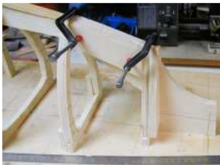
← Der Bugbereich zur Verstärkung wird ausgefüllt, so ein Segler hat eben keine Notbremse oder gar einen
