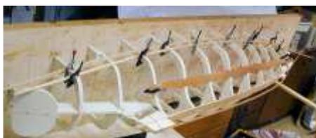
← Decks- und Bordwandlinie werden angezeichnet, die Spanten ausgespart und dann die Leisten eingeklebt. Die Kielleiste ist hier provisorisch untergehängt, ebenso die Musterplanke zum Straken aufgelegt.
