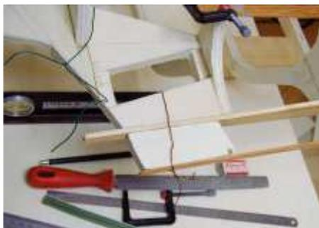
← Ebenso das Heck, wobei gleich der Kanal für den Jet-Antrieb ausgespart wurde
