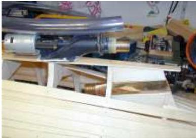
← Der Jet-Antrieb, vorbereitet zum späteren Einbau (den Hintergrund möge man mir verzeihen)
