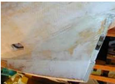
← Hier sind Ein- und Austrittsöffnung des Jet-Antriebes zu sehen. Ausgerechnet am hinteren Ende war die Kielleiste verzogen und mußte aufgespachtelt werden.
