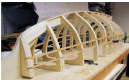
← Die Kielleiste (Kielschwein) aufgelegt, der eigentliche Kiel wird erst nach dem Laminieren aufgeklebt. Die Endstücke am Bug und an Heck werden eingepaßt, Aussteifungen zwischen den Spanten eingepaßt
