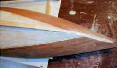
← Der Steven ist schon zugearbeitet und wird erst nach der Beplankung aufgeklebt und verschliffen. So erreicht man einfach einen sauberen Abschluß der Leisten.
