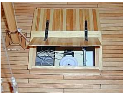
Die Decksluken lassen sich bequem zu Servicearbeiten öffnen
