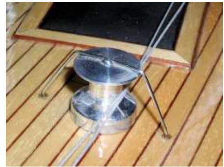
Bild 5: Um beide vordere Winschen ist jeweils ein Abweiser aus Edelstahl draht angebracht, damit sich die losen Schoten der Genua nicht um die Winsch legen können. Im Deck selber stecken die Enden des Drahtes jeweils in einem "Messingdübel".
