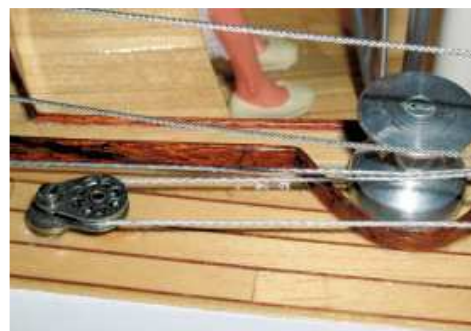
Bild 3: Anstelle der einfachen Umlenkrollen von robbe kommen jetzt kugelgelagerte und seewasserfeste Blöcke von Cap Marquettes (MKP) zum Einsatz. Neben einem attraktiven Erscheinungsbild ein weitere Zugewinn an Leichtgängigkeit.
