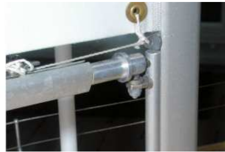
Bild 12: Der Baumadapter wird mit Epoxy-Kleber in den Baum eingeharzt. Es ist darauf zu achten, dass Baum und Adapter eine Flucht bilden und keine Neigung zustande kommt, ansonsten steht später der Großbaum nicht rechtwinklig zum Mast.
