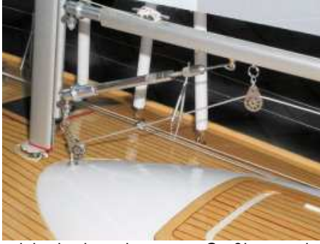
Bild 15: So sieht das komplette neue Großbaumgelenk im montierten Zustand aus. Über die Verstelle schraube am Niederholer reguliert man dessen Spannung. Die Drehachsen von Niederholer und Großbaum sind identisch, was in Verbindung mit der Kugellagerung für eine extreme Leichtgängigkeit des Großbaumes sorgt.
