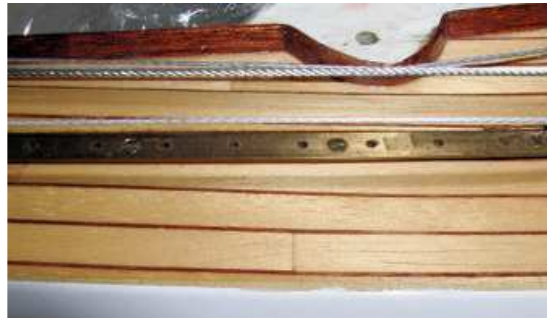
Bild 7b: Die Befestigungslöcher sind so weit anzusenken, dass die Senkköpfe der Messing- oder VA-Schrauben vollkommen plan mit der Oberfläche abschließen und nicht überstehen.
