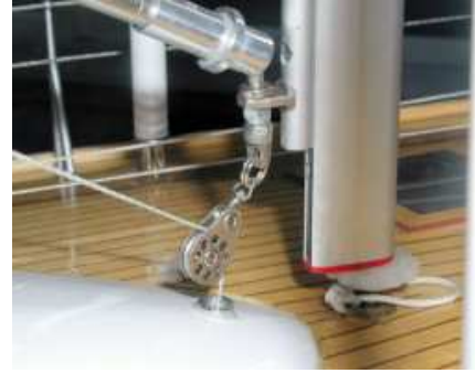
Bild 16: So sieht die fertige „Augenkopfschraube mit Innengewinde“, angeschraubt an dem überstehenden Teil der M2-Schraube der unteren Niederholer-Befestigung, aus. Damit läuft die Schot senkrecht aus dem Deck und wird über die Rolle des Blocks leichtgängig geleitet.
