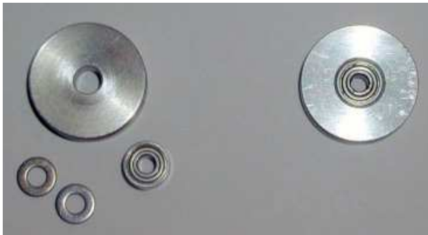
Bild 4: Aus diesen Einzelteilen entsteht die kugelgelagerte robbe-Umlenkrolle (rechts). Die Innenbohrung der robbe-Rolle wird so weit aufgeböhrt, dass das Kugellager stramm eingepreßt werden kann. Die beiden Unterlegscheiben müssen je nach erforderlichem Abstand im Halter abgefeilt werden.
