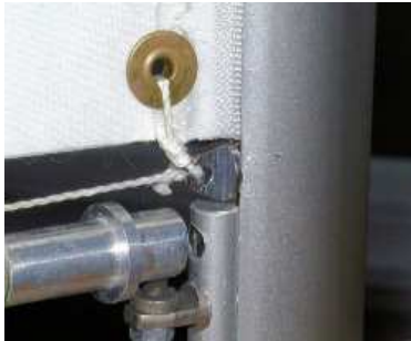
Bild 11: Unmittelbar oberhalb der Grundplatte ist eine Augenschraube an einem Nutenstein aus Aluminium verschraubt. So kann man die Augenschraube leicht am Mast befestigen, verschieben und bei Bedarf auch wieder lösen.
