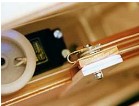
Umlenkeinheit Fock- und Großschot.
