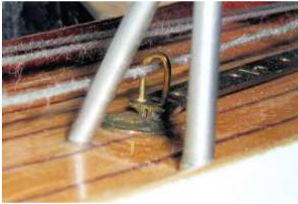
Bild 8: Der Führungsbogen aus 1 mm-Messingdraht wird von der Unterseite der Travelerschiene her in seinen Befestigungslöchern verlötet.
