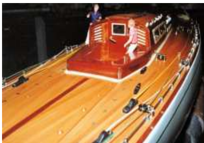
Deck mit Schotdurchführungen
