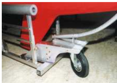
Unterwasserschiff der neueren Konstruktion mit dem Transportwagen
