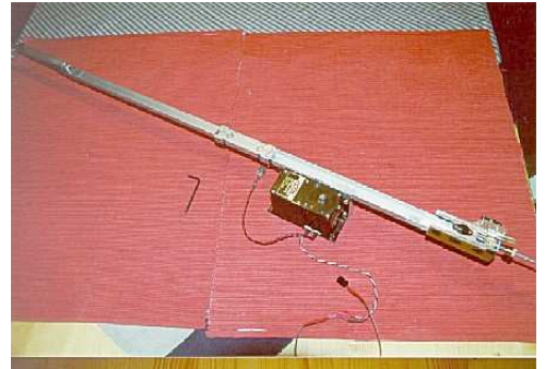
Foto 1: Das Windengerüst arretiert im ausgefahrenen Zustand, so wie es im Modellrumpf später eingebaut wird
